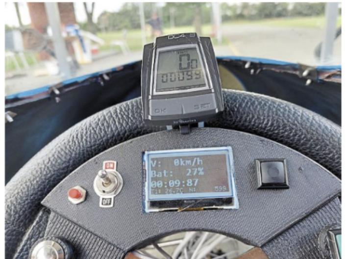
La réplique de Bugatti de l'IUT se pilote grâce à un volant de kart. On y retrouve toutes les informations, comme la vitesse ou la charge de la batterie, qui prend le relais si le ciel se couvre trop.
