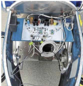
En-dessous de la coque bleue du véhicule se cache l'électronique qui gère la charge solaire et le pilotage du moteur.
